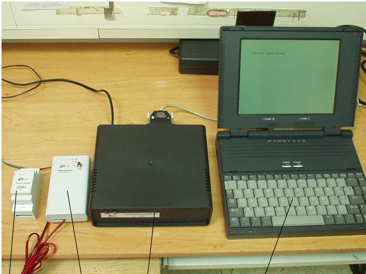
Slika 6 . – Komponente nadzornog sustava: 1.- Ispravljač PS 9V=/1A DIN 35 2.- Sensor transmitter STx-1A 3.- Centralna jedinica LMS-08A 4.- Operatorska konzola
